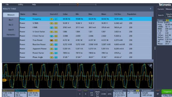
Таблица измерений качества источников питания. Функции автоматического измерения параметров питания позволяют быстро и точно анализировать общие характеристики источников питания.
