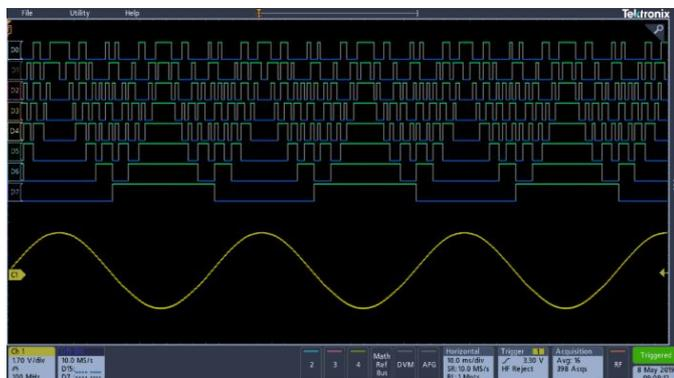
Осциллограф серии 3 с опцией 3-MSO используется для одновременного отображения аналоговых и цифровых сигналов на входе и выходе исследуемого ЦАП.
