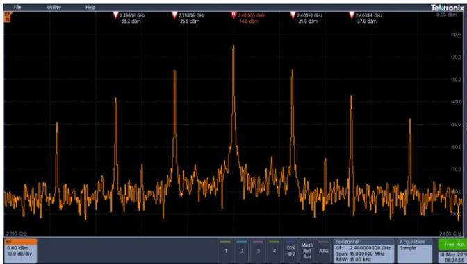
Автоматические маркеры пиковых значений позволяют наглядно представлять важную информацию. На рисунке показаны пять самых высоких амплитудных пиков. Они автоматически обозначены маркерами, поскольку превышают пороговые значения и величину показателя отклонения; для каждого маркера приведены значения пиковой амплитуды и частоты.
