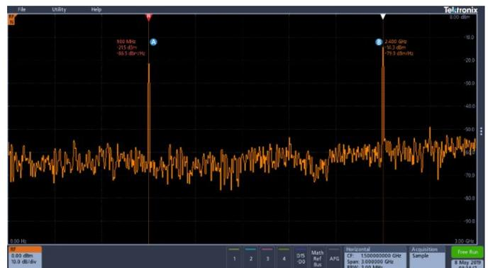
Отображение спектров сигналов пакетной передачи данных, полученных за один захват, на входе и выходе преобразователя протокола Zigbee (900 МГц) в протокол Bluetooth (2,4 ГГц).
