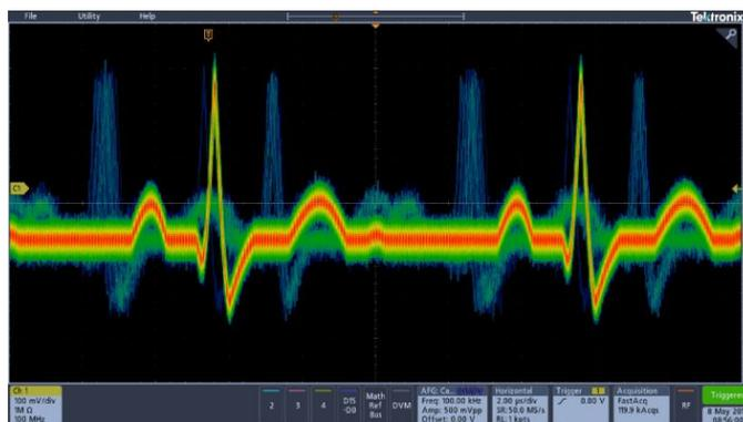
Технология цифрового люминофора с режимом захвата FastAcq поддерживают скорость захвата более 280 000 осциллограмм в секунду и отображение градаций яркости в режиме реального времени.
