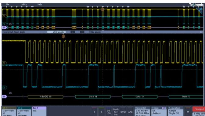
Запуск по конкретному пакету данных, передаваемому по шине I<sup>2</sup>C. Желтая осциллограмма представляет собой сигнал тактовой частоты, а синяя – данные. Осциллограмма сигнала шины показывает декодированное содержимое пакета, включая Старт, Адрес, Чтение/Запись, Данные и Стоп.
