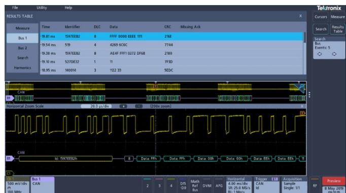
Таблица событий отображает декодированные идентификатор, код длины данных (DLC), данные и контрольную сумму (CRC) для каждого пакета шины CAN в течение длительного захвата.
